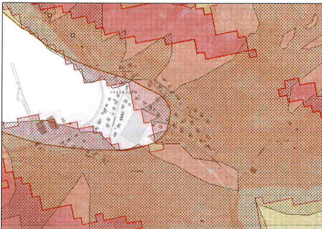
Figur 11 Skredfare i området. Utløpsområde for snøskred og aktsomhetsområde for jord- og flomskred. Kilde: NVE
